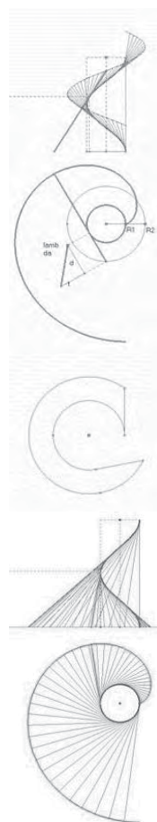
110. Geometrie di costruzione dell'elicoide sviluppabile
